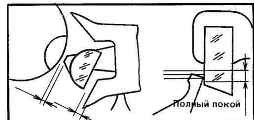
– смещен эллипс по отношению к выемке в предохранительном ролике
