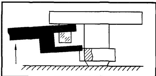
При выборке осевых и радиальных зазоров вилки и баланса рожки не должны касаться импульсного ролика
