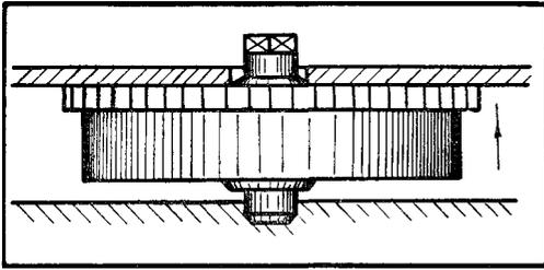
При выборе зазоров должны быть гарантированные расстояния между барабаном и мостом, барабаном и платиной, барабаном и плоскостью колеса
