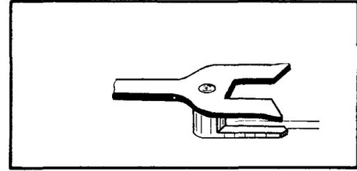
Запрессовка эллипса должна быть в пределах верхней плоскости импульсного ролика
