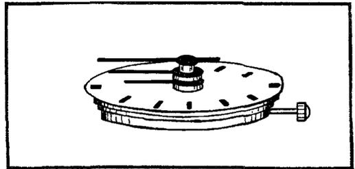
— приподнят циферблат — сломана ножка циферблата
