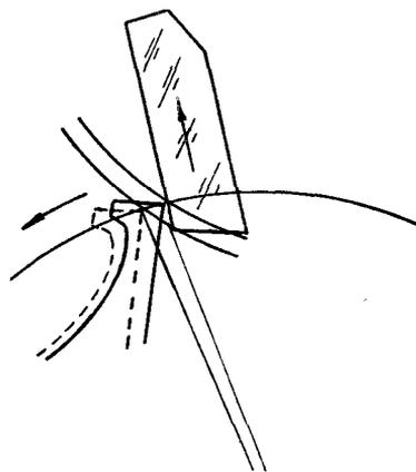
После отхода назад зуб анкерного колеса скользит по плоскости импульса. Импульс продолжается до тех пор, пока пятка зуба анкерного колеса не пройдет плоскость импульса палеты. Угол, пройденный за это время анкерным колесом, называется углом импульса колеса. Затем анкерное колесо проходит углы внутреннего и внешнего падений.
