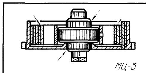
– несоосность отверстий корпуса и крышки барабана
