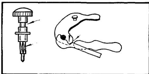
Зажат рычаг кулачковой муфты фиксатором переводного рычага
