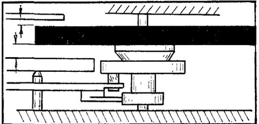
Колонка спирали должна быть установлена на уровне крепления спирали в колодке. При выборке осевого зазора баланса (вверх) должны быть гарантированные расстояния между спицей баланса, колонкой и замком регулятора
