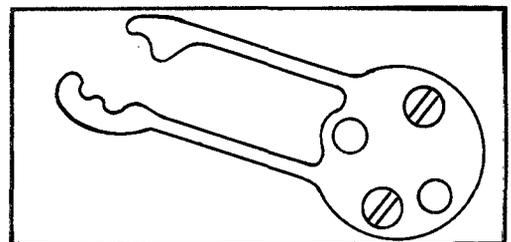
Не довернут или провертывается винт пружины переводного рычага – приподнят переводной рычаг
