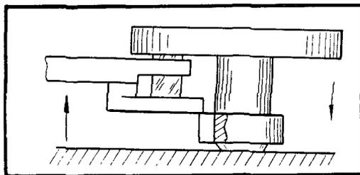
При выборке зазора вилки должно быть гарантированное расстояние между копыем и эллипсом
