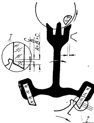
Угол, на который поворачивается вилка с момента падения зуба на палету до соприкосновения вилки с ограничительным штифтом, называется углом потерянного пути, который необходим для компенсации погрешностей деталей хода. Потерянный путь вилка проходит за счет притяжки.
