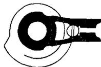
Крепление колонки в них осуществляется за счет пружинящих частей, передвижение колонки и извлечение ее из гнезда осуществляется за счет нажатия на ее торцы, вставка колонки осуществляется разжимом хвостовой части регулятора.
