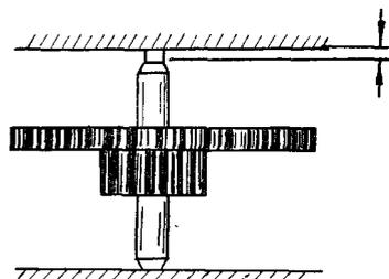
– глубина зацепления зубьев ( $h$ ) должна быть равной  $\frac{2}{3}$  высоты зуба ( $H$ );
