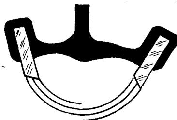
Во время работы часового механизма анкерное колесо, анкерная вилка и баланс находятся в определенном взаимодействии друг с другом, для чего необходима отладка параметров спускового механизма.
