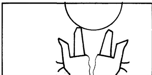
Зазоры в копые проверяются по обеим сторонам предохранительного ролика
