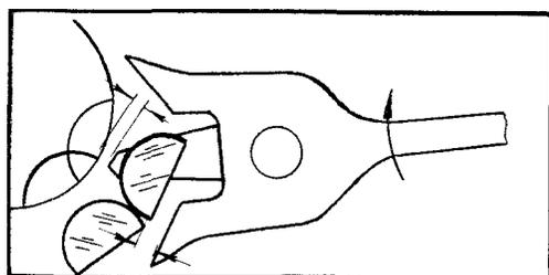
Запрессовка эллипса должна быть параллельно оси баланса и перпендикулярна плоскости двойного ролика
