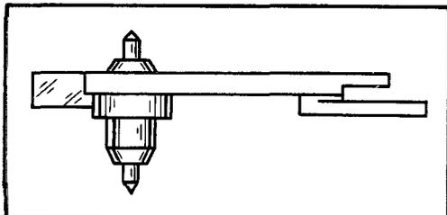
Камень должен иметь полированную поверхность и обеспечивать свободное перемещение вилки
