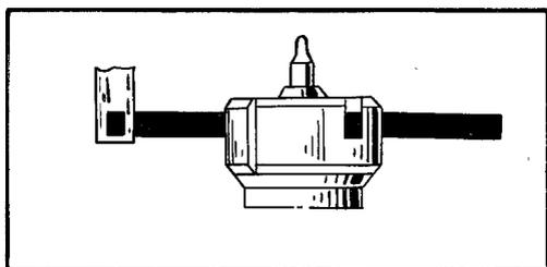
Напрессовка двойного ролика на ось должна быть с натягом, обеспечивающим прочность соединения при работе механизма
