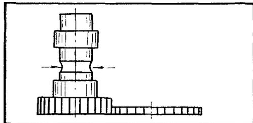
Зазоры должны обеспечивать глубину зацепления зубьев в пределах  $h = \frac{2}{3} H$
