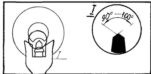
– мала выемка в импульсном ролике под копье
