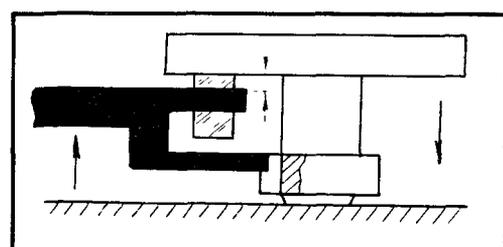
– высокая установка хвостовой части анкерной вилки
