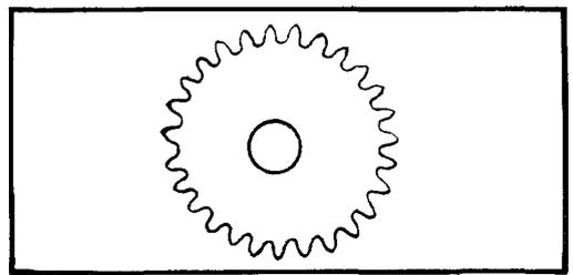
Велик осевой зазор, радиальный зазор (заводного, барабанного колес, собачки)
