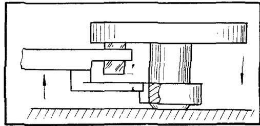
– высокая установка хвостовой части анкерной вилки
