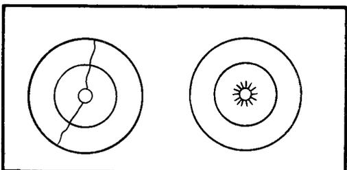
Не допускаются механические повреждения камней, влияющих на работу часового механизма
