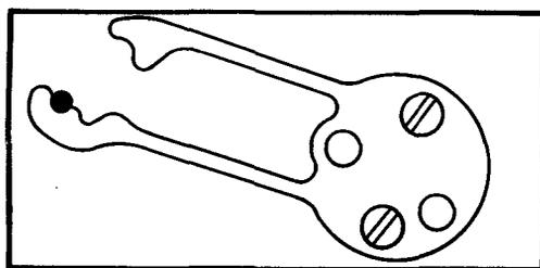
Сработана фиксирующая часть фиксатора
