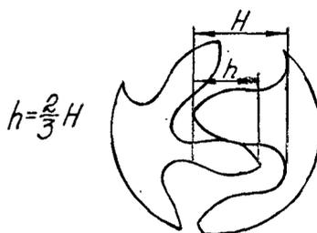
– при выборке осевых зазоров должны быть гарантированные расстояния между сопрягаемыми деталями.
