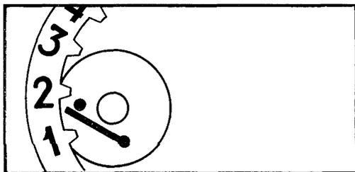
двойные, кулачкового типа, мгновенно-замедленного действия («Восток»-2428А, «Ракета»-2628Н). Ускоренная корректировка дат производится заводным ключом в третьем положении («Ракета»-2628Н);
