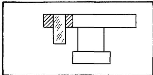
Копьё должно быть опилено под углом  $90^\circ$  до  $110^\circ$ . При опилковке копы не допускается отгибка копы (вверх, вниз), наличие заусенцев
