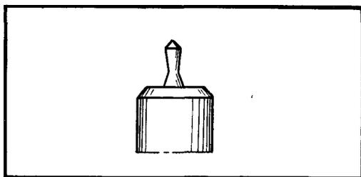
Дозировка масла  $\frac{1}{2}-\frac{2}{3}$  объема масленки камня предохраняет цапфы от износа
