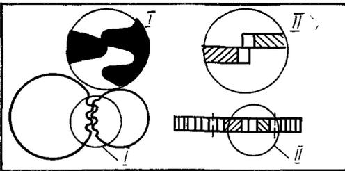
При проверке зазоров зубья взаимодействующих деталей не должны выходить из зацепления
