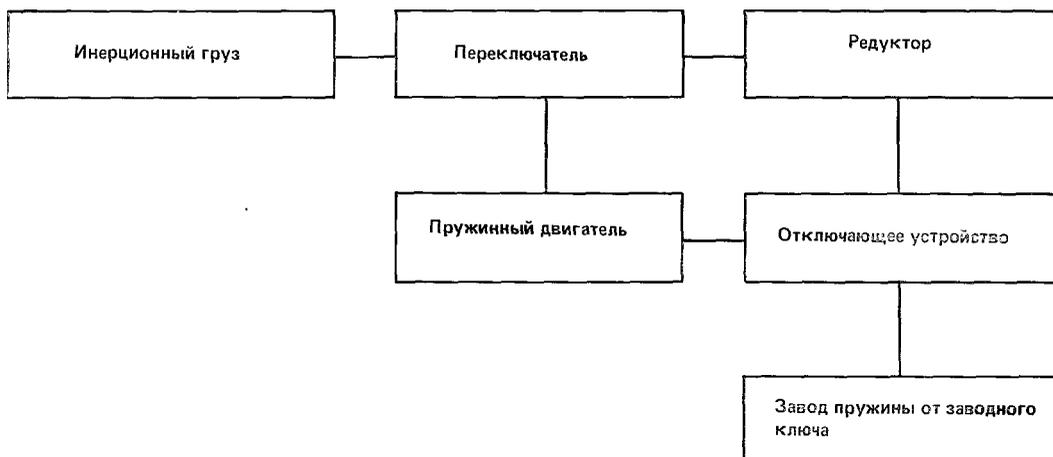
Инерционный груз преобразует различные движения руки во вращательное движение механизма автоподзавода; он должен обладать достаточным моментом для преодоления сопротивления заводной пружины.
