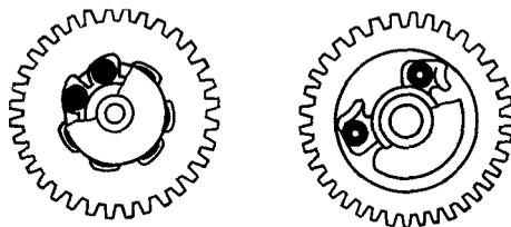
Редуктор (зубчатая передача) передает вращение и увеличивает момент инерционного груза, передаваемый на подзавод пружины.
