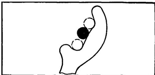
Фиксатор должен удерживать штифт переднего рычага в положениях «завод» и «перевод»
