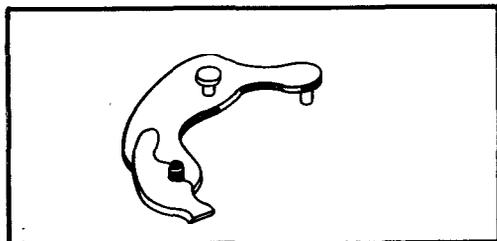
Сломана или деформирована фиксирующая часть фиксатора переводного рычага
