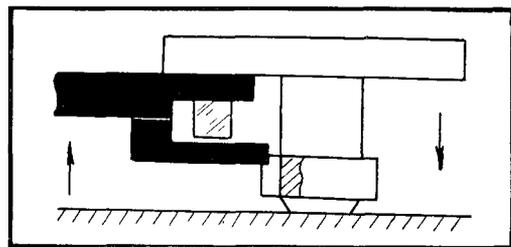
При выборке зазора вилки (вверх), баланса (вниз) между рожками и импульсным роликом должно быть гарантированное расстояние, обеспечивающее свободные колебания баланса
