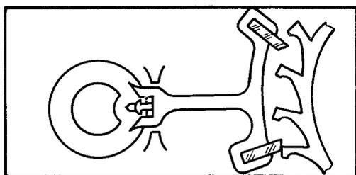
При работе механизма не должно быть прокручивания колодки на оси баланса
