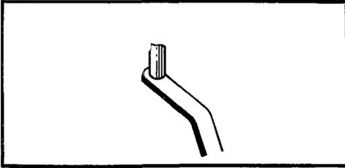
– велик осевой зазор молоточка или рычага выключения сигнала
