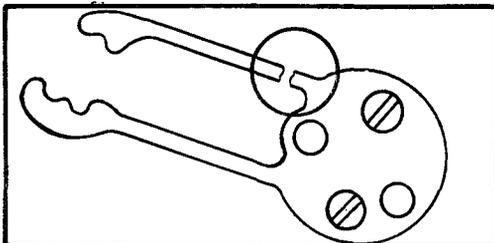
Пружинящая часть фиксатора или пружина переводного рычага должна удерживать ось переводного рычага в платине
