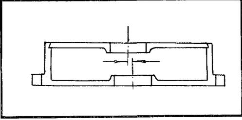
Не допускается смещение отверстий, препятствующих свободному вращению корпуса относительно вала барабана
