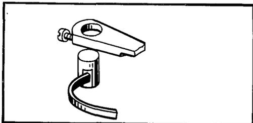
Винты крепления колонки должны быть довернуты до отказа, исключая их самоотвертывание
