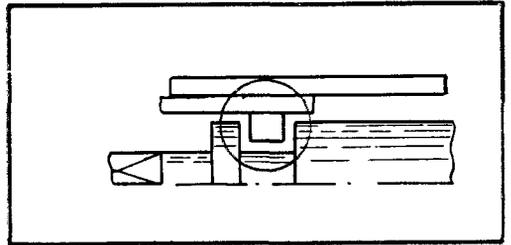
Сломана, деформирована пружинящая часть фиксатора переводного рычага
