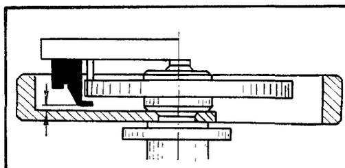
При спущенной заводной пружине эллипс должен находиться в пазу анкерной вилки, хвостовая часть вилки должна быть в середине между ограничительными выступами, зуб анкерного колеса должен быть в середине импульсной плоскости палеты. При заводе часов на 3–5 зубьев барабанного колеса должен быть самоспуск механизма. При проверке механизма на приборе ширина между линиями записи должна быть не более 2 мм
