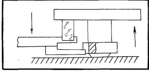
Установка хвостовой части вилки должна обеспечивать взаимодействие копыа и предохранительного ролика, рожек и эллипса во всех положениях механизма
