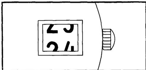
Несогласованность моментов усилий пружин – большое усилие пружины защелки, малое усилие пружины фиксатора дат
