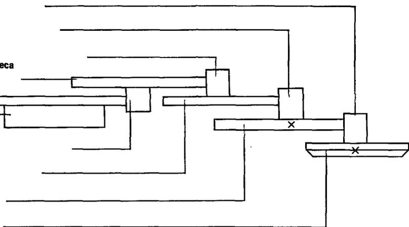
Качество работы колесной системы проверяют путем завода пружины на 3-4 зуба барабанного колеса, при этом скат должен быть плавным с обратным отходом анкерного колеса на 3-4 оборота (после раскручивания пружины). С этой целью к колесной системе предъявляются следующие требования:
