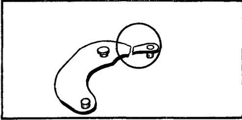
Переводной рычаг должен удерживать заводной вал в механизме
