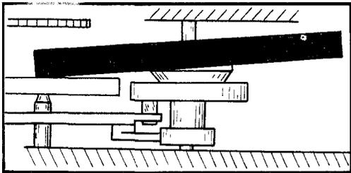
Задевание спицы баланса за колонку спирали или замок регулятора
