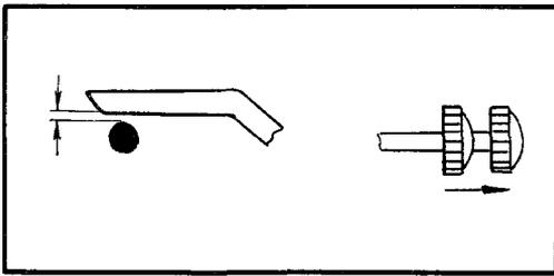
Нет перекрытия штифта молоточка рычагом выключения сигнала по высоте:
