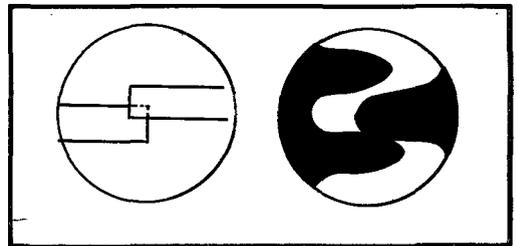
Не довернут, провертывается винт заводного колеса, барабанного колеса, собачки
