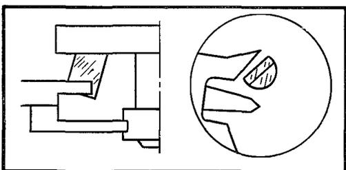
Задевание копы о выемку предохранительного ролика:
