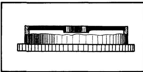
– отсутствует натяг крышки в корпусе барабана
