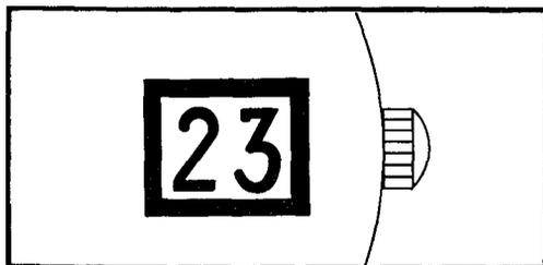
Усилие пружин должно обеспечивать перемещение указателя дат и фиксацию его на каждой дате. Дата должна просматриваться полностью в окне циферблата
