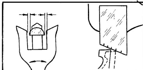
Большой зазор эллипса в пазу анкерной вилки
