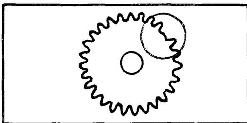
Приподнят минутный триб – отсутствует взаимодействие зубьев вексельного колеса с минутным трибом
