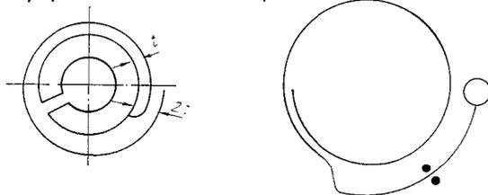
– расположение точек крепления внешнего и внутреннего витков спирали относительно друг друга, то есть расположение колонки спирали относительно выхода спирали из колодки;
