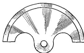
Переключатель (реверсивное устройство) преобразует двустороннее вращение инерционного груза в одностороннее вращение зубчатой передачи.
