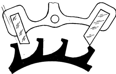
Если внутренний угол падения мал, анкерную вилку называют узкой. Если внешний угол падения мал, анкерную вилку называют широкой. Во время эксплуатации часы претерпевают смену положений, толчки и сотрясения, поэтому, чтобы анкерная вилка не могла самопроизвольно перебрасываться от одного ограничителя к другому, конструкция анкерного хода предусматривает предохранительные устройства:
