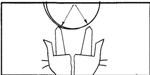
При повороте баланса от положения равновесия на  $90^{\circ}$ ,  $180^{\circ}$ ,  $270^{\circ}$  зазор в копые должен быть одинаковым
