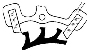
Угол, на который поворачивается анкерное колесо с момента, когда зуб сошел с импульсной плоскости выходной палеты, называется углом внешнего падения.
