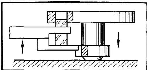
Запрессовка эллипса должна быть с натягом, на всю высоту импульсного ролика и параллельна оси баланса
