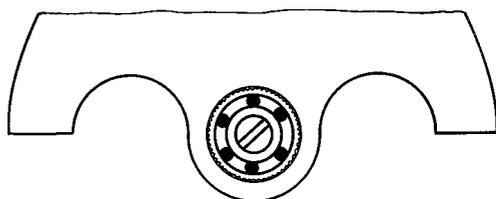
Наиболее распространенными являются опоры скольжения, но в последнее время для уменьшения трения и повышения прочности соединения деталей применяют опоры качения, т. е. ставят шарикоподшипники, которые позволяют увеличить радиус опоры, а значит жесткость и прочность опоры.
