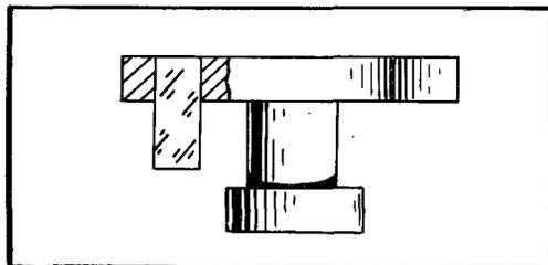
Палеты должны входить в пазы вилки с натягом. Не допускается перекося палеты относительно верхней плоскости скобы вилки. Шеллак должен обеспечивать надежное крепление палеты. При смазывании палет масло следует давать на середину плоскости импульса каждой палеты
