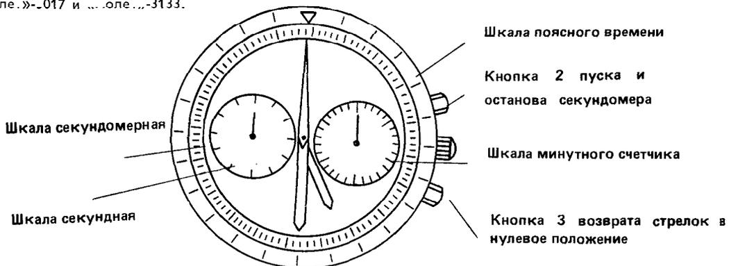
Управление работой секундомера осуществляется кнопками 2 и 3. Конструкция секундомера суммирующего действия позволяет суммировать промежутки времени нажатием на кнопку 2 после останова секундомера. Движение стрелок секундомера будет продолжено без возврата их в нулевое положение.
