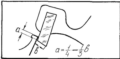
В положении равновесия вилки острие зуба анкерного колеса должно находиться в середине плоскости импульса палеты
