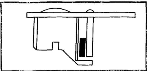
Биение спирали по плоскости допускается не более 0,015 мм. Плоскость спирали должна быть параллельна торцевой плоскости колодки и ободу баланса. Не допускается перегиб спирали выше или ниже уровня заштифтовки ее в колодке
