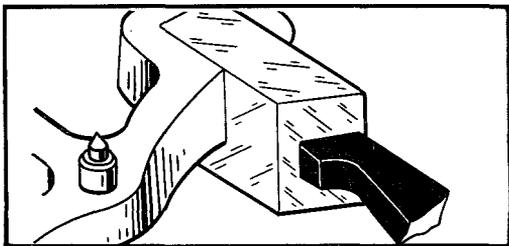
Проверку взаимодействия зуба анкерного колеса и палеты следует производить на всех зубьях колеса при выборке осевого и радиального зазоров анкерной вилки в направлении к анкерному колесу
