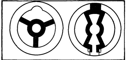
Зазоры должны обеспечивать свободное колебание баланса в любом положении механизма. При проверке амортизационных зазоров шатон с накладным камнем должен вернуться в исходное положение под действием упругой силы фиксирующей пружины
