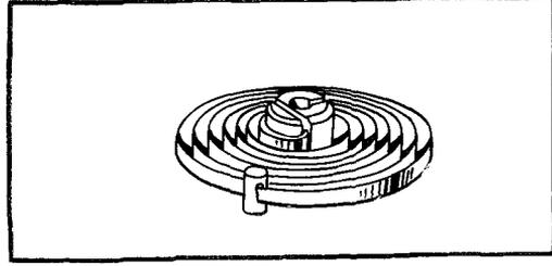
Внутренний виток спирали должен находиться на расстоянии 1–1,5 шага спирали от диаметра колодки. Не допускается резкий перегиб спирали (колена) при выходе ее из колодки
