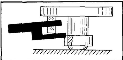
При установке хвостовой части копые должно быть в пределах верхнего и нижнего торцов предохранительного ролика
