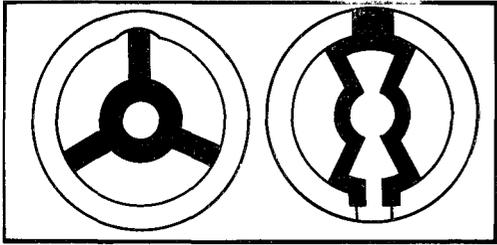
Заклинивание баланса при выборке осевого и радиального зазоров (не срабатывает противоударное устройство, деформирована фиксирующая пружина)
