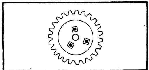
Тугое вращение часового колеса (часовое колесо зажато пластиной колеса освобождения)
