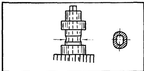
Глубокое зацепление зубьев кулачковой муфты, переводного и вексельного колес, минутного триба
