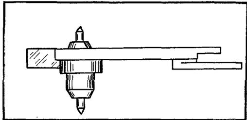
Задевание копы за платину (или накладку противоударного устройства):
