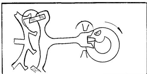
Мал зазор эллипса в пазу анкерной вилки (затирание эллипса в пазу)
