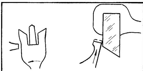
Зазор в пазу должен обеспечивать свободный вход и выход эллипса при работе механизма. При проверке зазора в лапу зуб должен перемещаться на  $\frac{1}{5}-\frac{1}{6}$  величины импульса палеты
