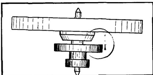
Напрессовка двойного ролика на ось баланса должна быть с натягом, до упора
