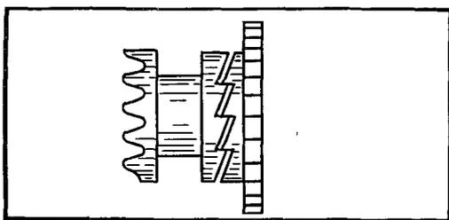
– отсутствует зазор между переводным рычагом и рычагом кулачковой муфты
