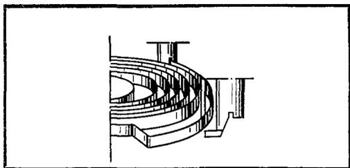
Смещение центра спирали допускается не более  $1/2$  расстояния между витками (шага) спирали. Оценку концентричности спирали следует производить при спущенной заводной пружине. При работе механизма спираль не должна задевать за детали
