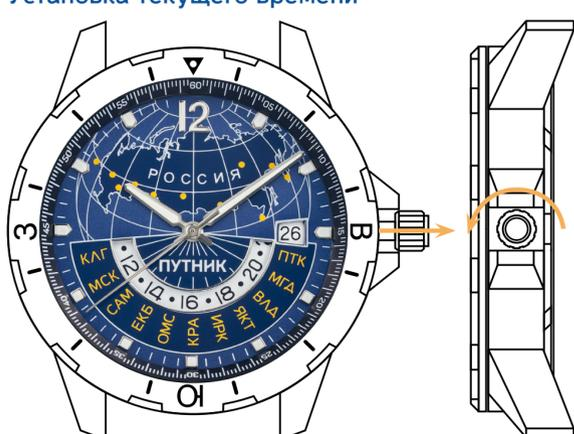
Чтобы установить текущее время на Ваших часах, Вам нужно выдвинуть головку в положение коррекции текущего времени. Для этого просто потяните головку в сторону от боковой части корпуса, пока не почувствуете **второй** легкий щелчок.
