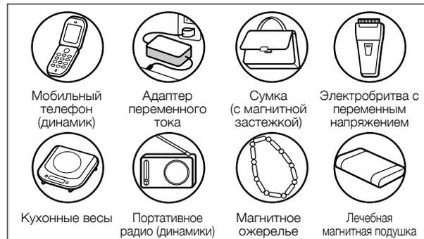
Детали часов могут намагнититься в зависимости от силы магнитного поля, в результате чего часы потеряют точность хода. В этой ситуации часы должны пройти процедуру размагничивания и настройки точности хода. Обратите внимание, что эта процедура платная, даже если она проводится до истечения гарантийного срока.
