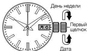
③ Вытяните заводную головку до второго щелчка, когда секундная стрелка находится в позиции 12 часов. Секундная стрелка сразу же остановится. Вращайте заводную головку, чтобы стрелки двигались вперед до тех пор, пока на циферблате не появятся нужная дата.
