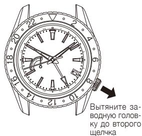
④ Вращайте заводную головку против часовой стрелки, чтобы настроить 24-часовую и минутную стрелки на текущее время. Установите минутную стрелку немного раньше желаемого времени, а затем медленно переместите ее вперед до нужной отметки.
