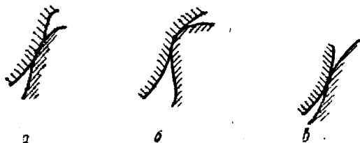
Фиг. 44. Соприкасающиеся профили в зубчатых зацеплениях при различных формах зубьев.
