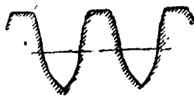
Фиг. 43. Профиль зубьев червячной фрезы для нарезания промежуточного колеса часового механизма.
