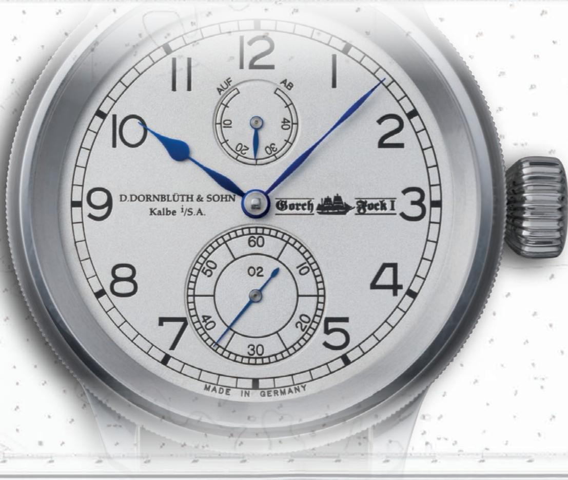
**Gehäuse:** poliert/satinierter aus nickel-freiem Edelstahl, doppelt verschraubt • Ø 47 mm • Höhe 12,1 mm • 1,6 mm dickes, flaches Saphirfrontglas, außen und innen entspiegelt • verschraubter Saphirglasboden mit Gravur der Sonderedition • großdimensionierte Aufzugskrone • Schraubstege
